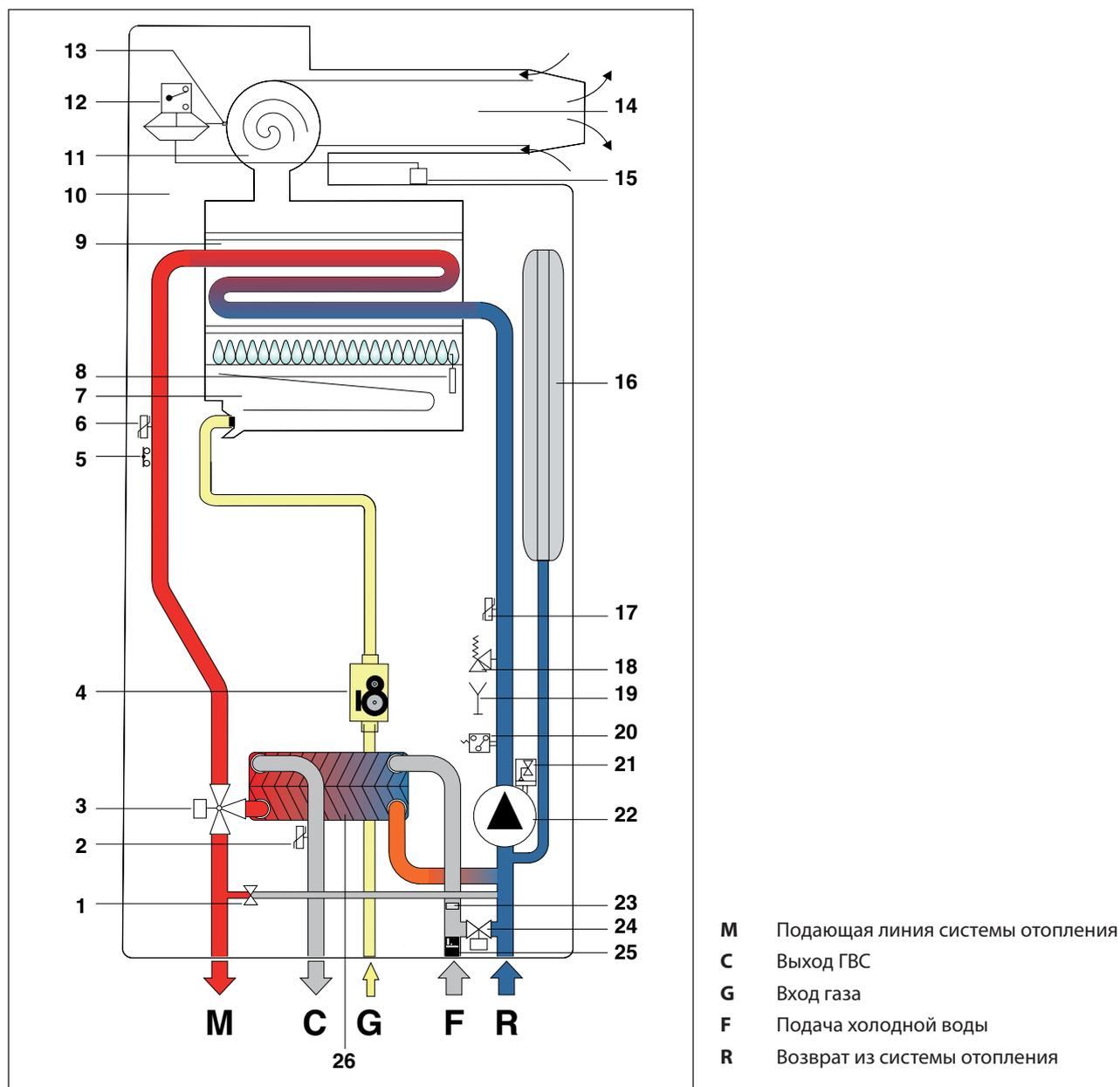
Рис. 4 Гидравлические схемы
